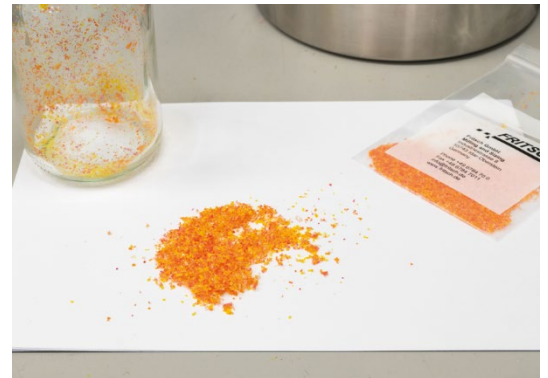
Abb. 4: Latexprobe zerkleinert mit Siebschalen 1 mm Trapezloch
